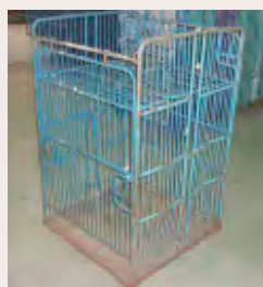
旧型ボックス。鉄製の側面パーツと鉄製の枠に合板をはめたパレットを組み立てて使用します
