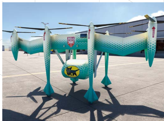
※ イメージ図 ベルヘリコプターの電動垂直離着陸機 APT70 飛行速度：時速160km以上 積載量：35kg (今後実証実験を通じて、450kgまで大型化する可能性あり)
