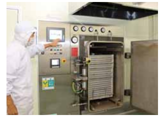
助成で購入した圧力容器は加熱、調理、殺菌、冷却までできると小野昭男社長
