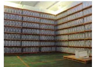
角氷1枚が約143kg 1日約50tの製氷能力があり、 約2000tを貯氷できる
