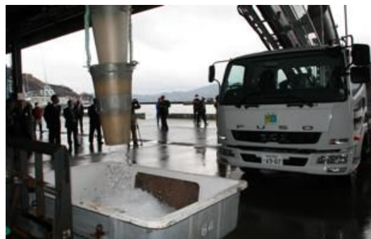
殺菌冷海水製造装置は、常時1℃の殺菌海水を供給でき、水よりも魚体を痛めずに鮮度を保持できます
