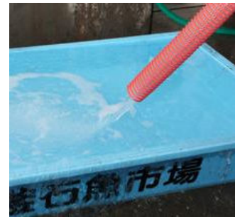
殺菌冷海水製造装置は、常時1℃の殺菌海水を供給でき、水よりも魚体を痛めずに鮮度を保持できます
